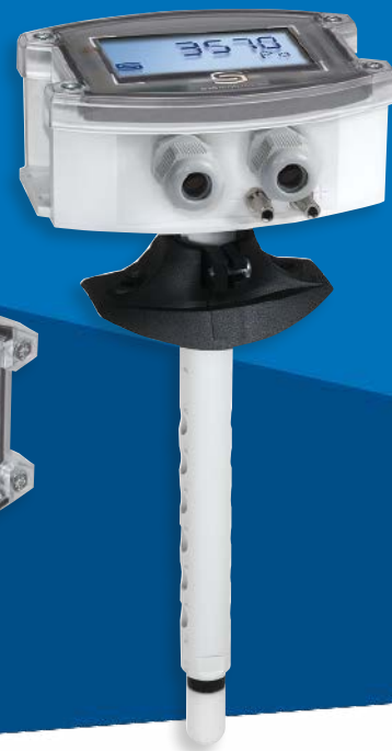
PREMASGARD® 8147 - Modbus Sonde/convertisseur de mesure multifonctions pour montage en gaine, pour l'humidité, la température, la pression, la pression différentielle et le débit volumétrique avec écran
